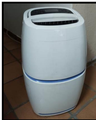
Deshumidificador Temperatura y humedad relativa
